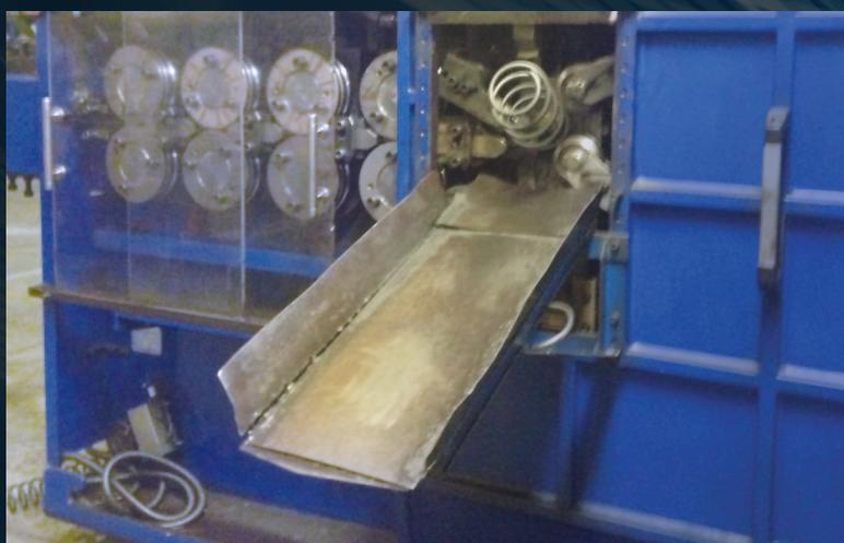
Il processo di avvolgimento a freddo garantisce geometrie perfette sia per molle cilindriche che per coniche e biconiche, in range di diametri da 8.00 a 16.50 mm.
